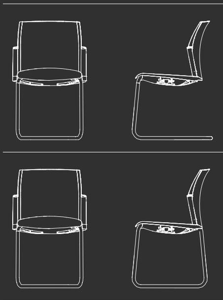
Windstart en su versión cantilever y patín trineo montan sus bases en tubo de sección redondo de 20 mm de diámetro
